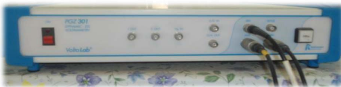
Figure 9 : potentiostat-galvanostat utilisé pour la voltammétries.
