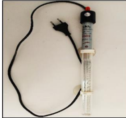
Figure 15 : thermostats la puissance est 300 watt
