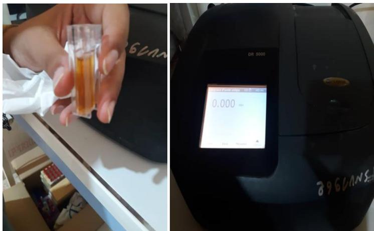
**Figure 17** : photo de spectrophotomètre pour les sucres totaux
