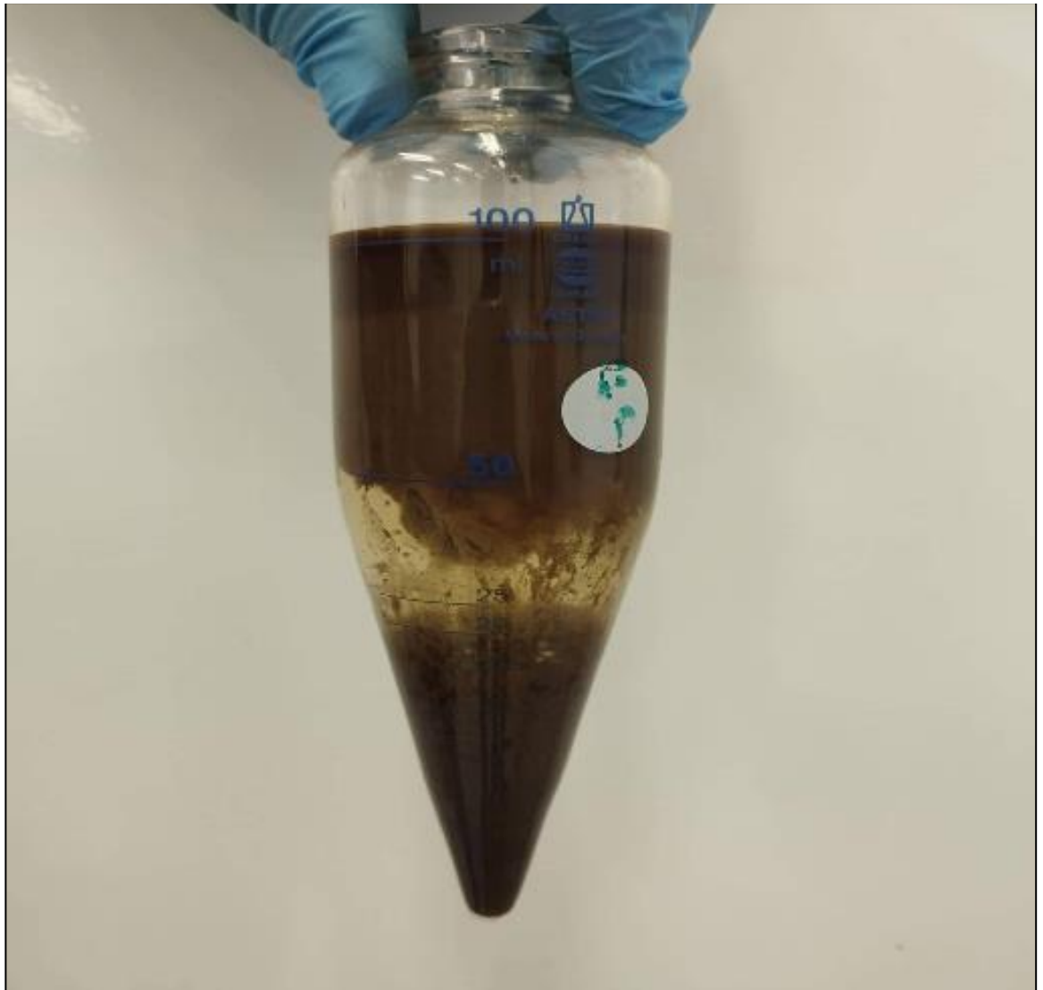
Photo N° 2 : Procédure de lecture de l'eau et des sédiments lors de l'utilisation d'un tube à centrifuger en forme de cône ASTM de 100mm.
