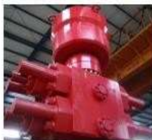
Figure I. 8: monte un obturateur.
