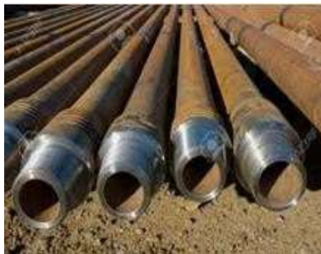
Figure I. 10: Les tiges de forage.
