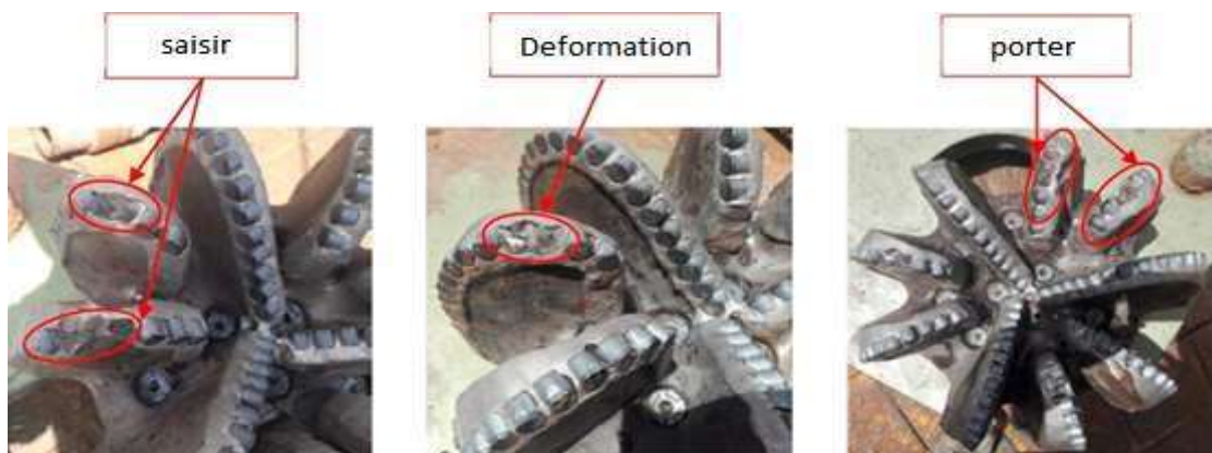
Figure I. 17: Détérioration du foret due aux vibrations saccadées dans les hydrocarbure algérien influence de (WOB/ROP)
