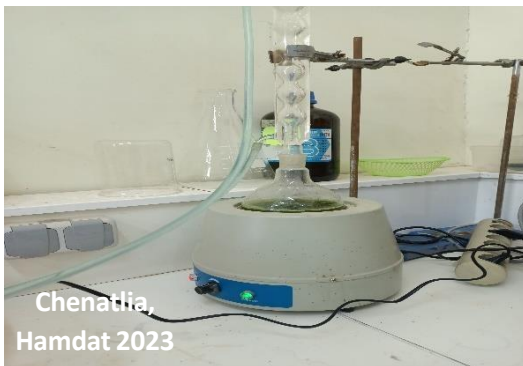
Figure 15- Dispositif d'extraction par reflux
