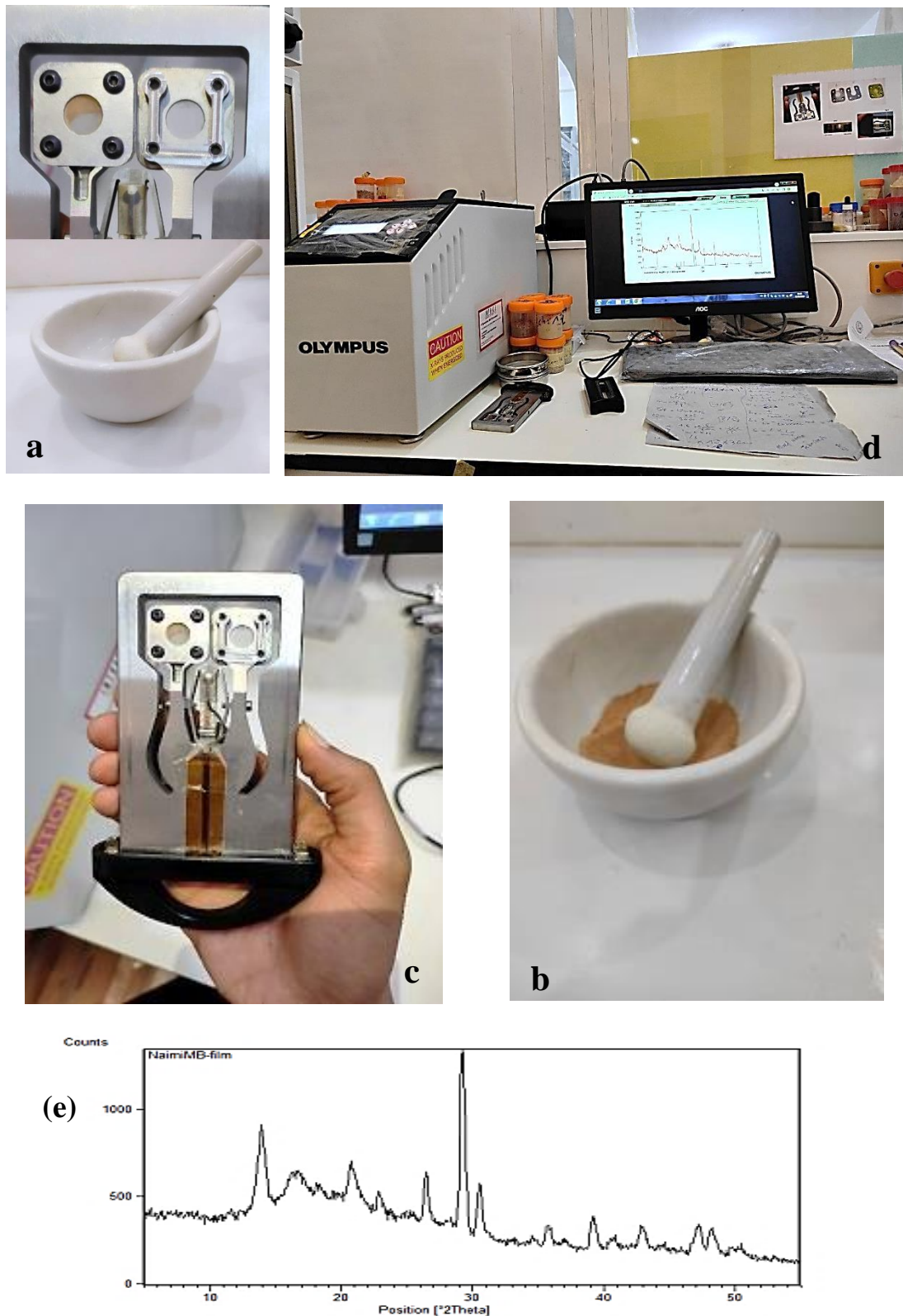
Figure 9 : a) Matériel de préparation des échantillons, b) mise en poudre de l'échantillon, c) porte-échantillon, d) appareil de diffractométrie de type BTX-716, e) Exemple de composition minéralogique du marne de Djebel Azzedine.
