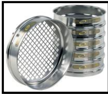
Figure II.3 : Analyse granulométrie par voie humide.
