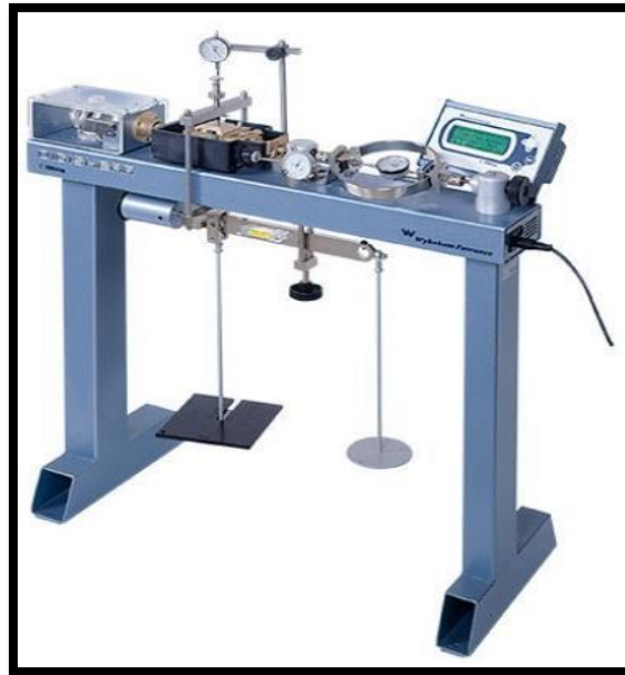
Figure II.7: Appareil de l'essai de cisaillement
