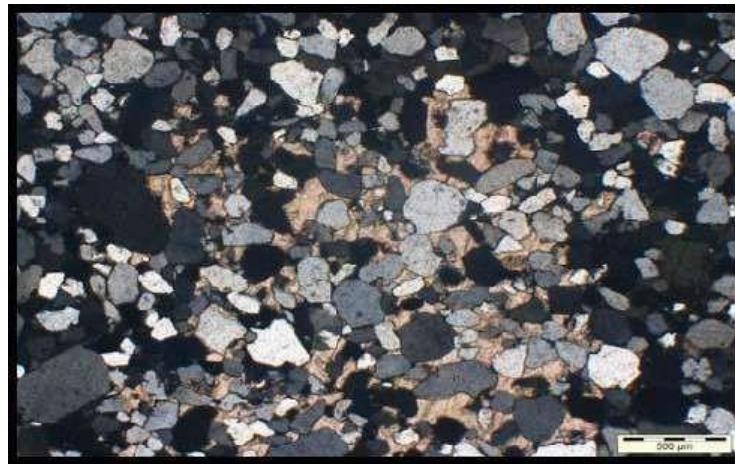
Ph 1 : Photo montrant les grains de quartz mal classé (puits RAMA-1 / Cote : 4001.51m)
