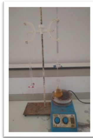
الشكل (III.06) يمثل معايرة البيروكسيد IP وفق ISO 3961 :2018
