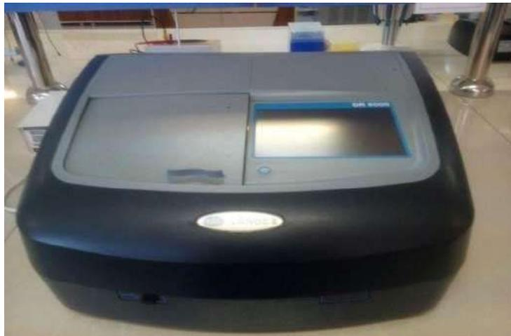
*Figure III.5: Spectromètre UV-Visible(R-6000)*
