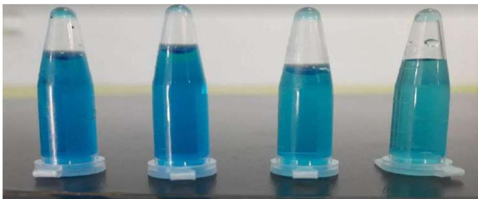
*Figure IV.5* Changement de couleur de bleu de méthylène en fonction du temps d'irradiation
