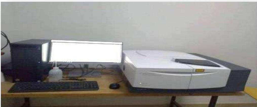
*Figure III.8 : Spectroscopie infrarouge a transformé de fourrier (FTIR).*
