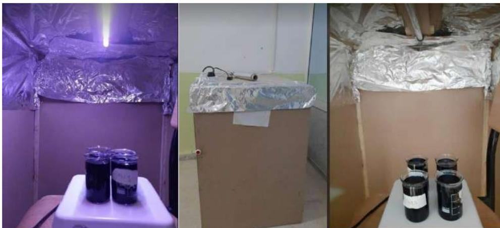
**Figure III.10 : Montage expérimental utilisé dans les essais de photocatalyse au bleu de méthylène**
