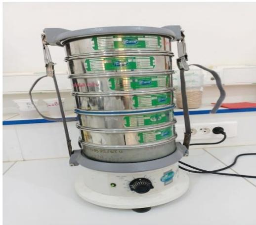
**Figure IV-3 :** tamiseuse électrique a vibration
