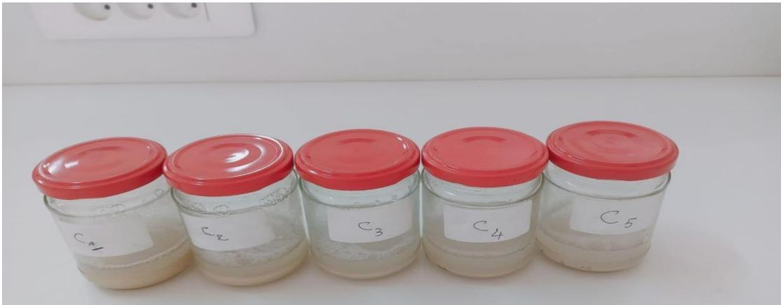
**Figure IV-10 :** Photo des essais d'adsorption en variant le temps de contact
