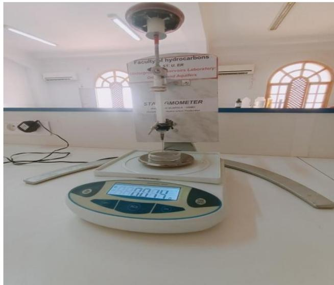
**Figure IV-8 : Stalagmomètre**
