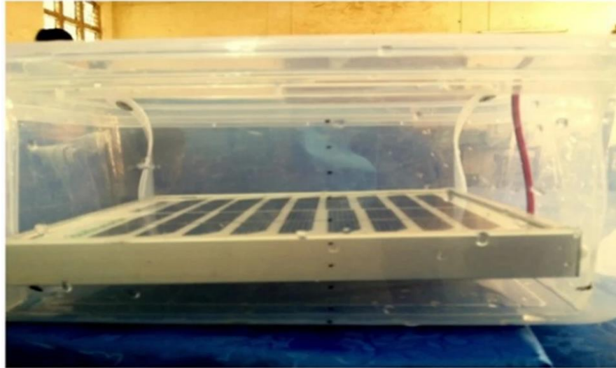
Figure II.12 : Panneau immergé dans l'eau [31]
