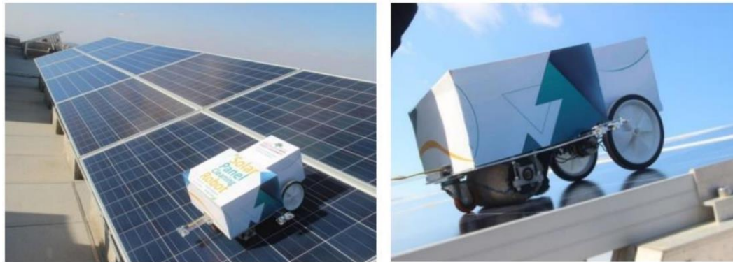
Figure II.5 : Nettoyage intelligent des panneaux solaires. [13]
