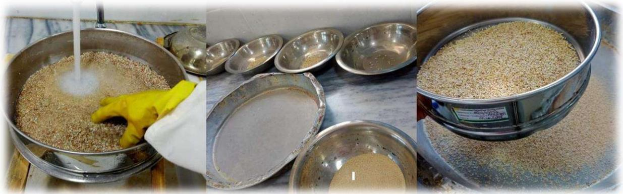
**Photo II.2 : Analyse granulométrique par tamisage du sable concassé**
