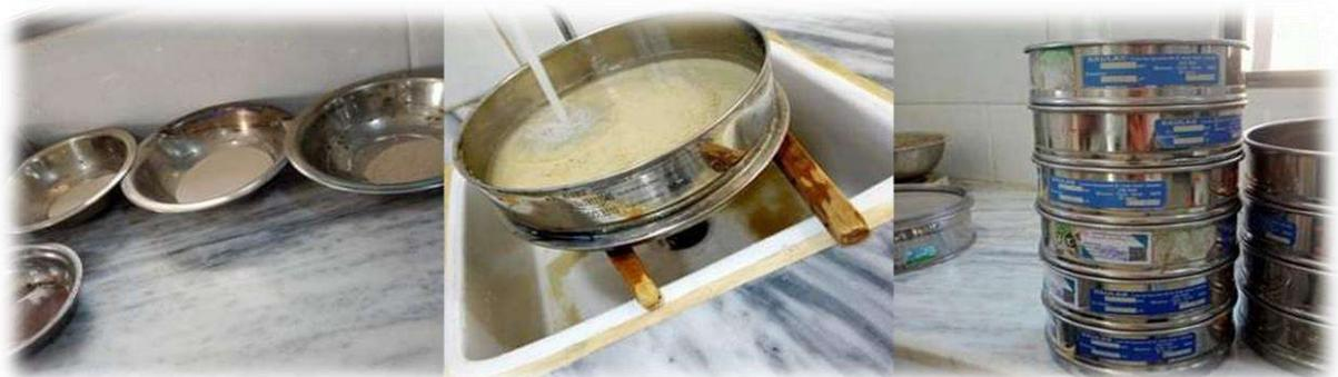
Photo II.1 : Matériel pour analyse granulométrique
