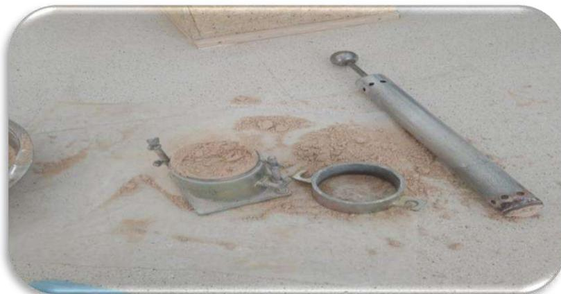
**Figure III.3 : Matériels pour essai Proctor**
