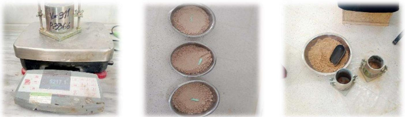
**Figure III.4 : Déroulement de l'essai Proctor**
