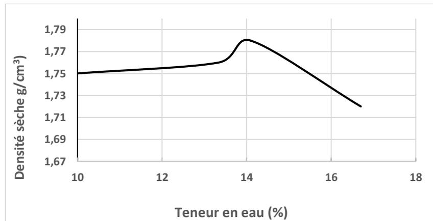
Figure III.5 : Courbe Proctor Normal (0% de sable concassé)
