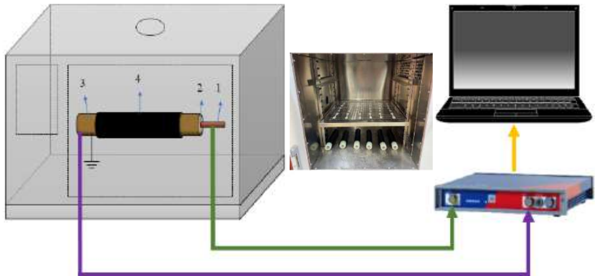
Figure II.10. Banc d'essai pour caractériser l'isolation d'un câble souterrain [53]
