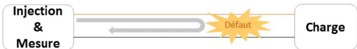
Figure I.18. Principe de la réflectométrie
