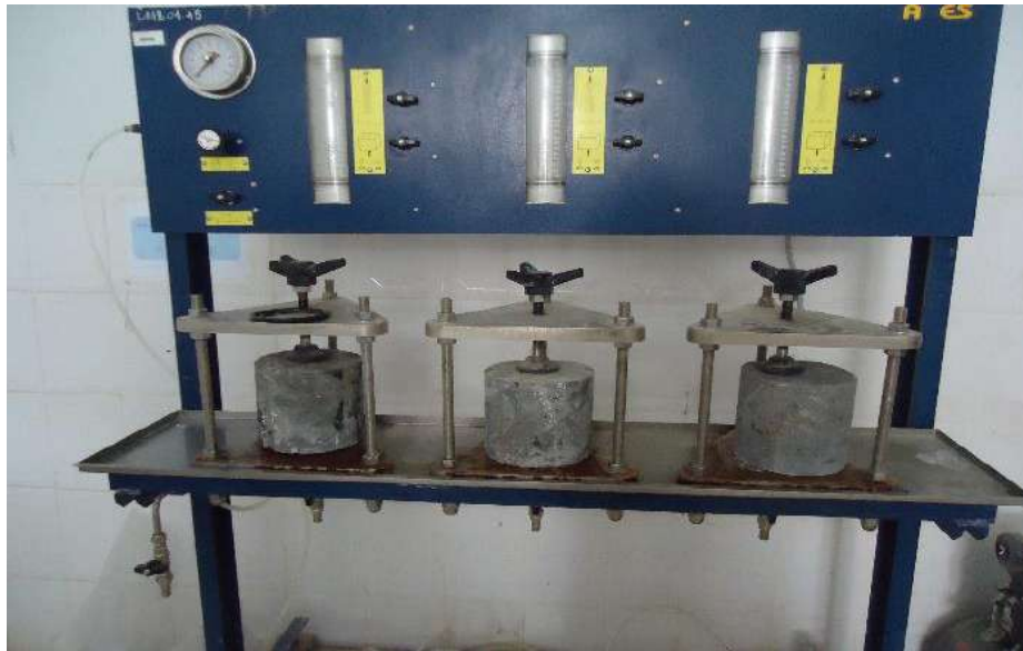
Figure III.3 Perméabilimètre à béton
