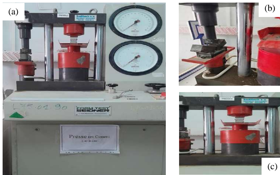
Figure III.10 Équipement utilisée pour les essais mécaniques sur les mortiers; (a) vue d'ensemble, (b) partie destinée à l'essai de flexion et (c) partie destinée l'essai de compression
