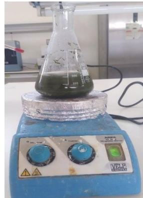
الخليط فوق جهاز الرج المغناطيسي تحت درجة حرارة 50 مئوية
