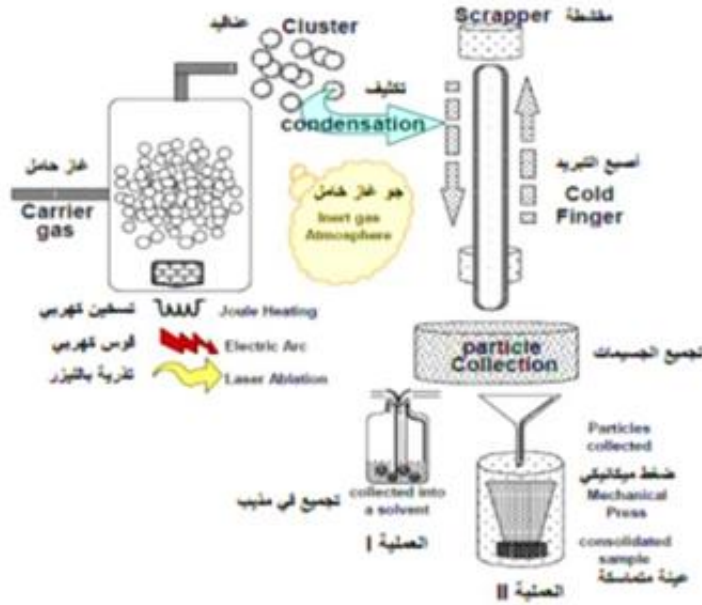
الشكل (1-19) رسم تخطيطي لعملية تكثيف الغاز الخامل لتحضير مواد ذات بنية نانومترية {9}
