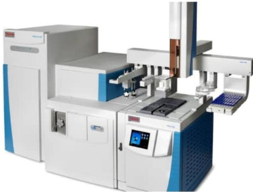
الشكل (9.IV) : جهاز كروماتوغرافيا الطور الغازي مع مطيافية الكتلة (GC-MS)
