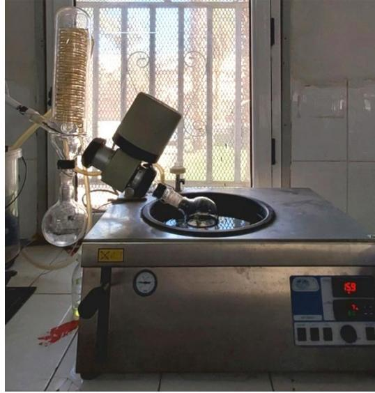
الشكل (6.IV) : عملية تبخير المذيب بواسطة جهاز التبخير الدوار
