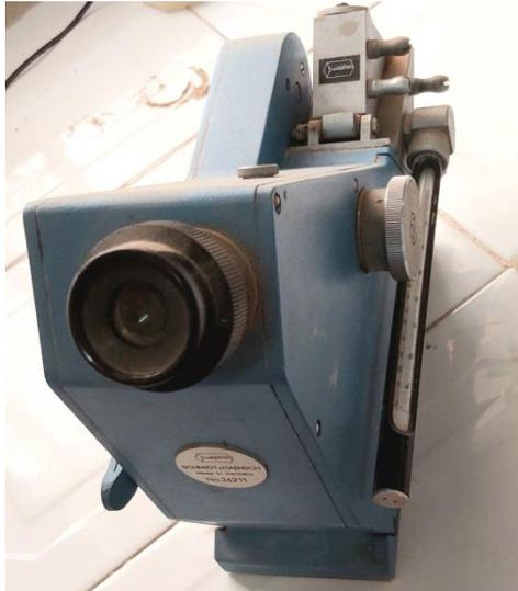
الشكل (8.IV) : جهاز قياس قرينة الانكسار
