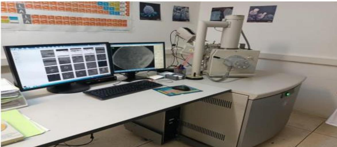
4-II الشكل : جهاز المجهر الإلكتروني الماسح (Baloyage électronique Microscopie)
