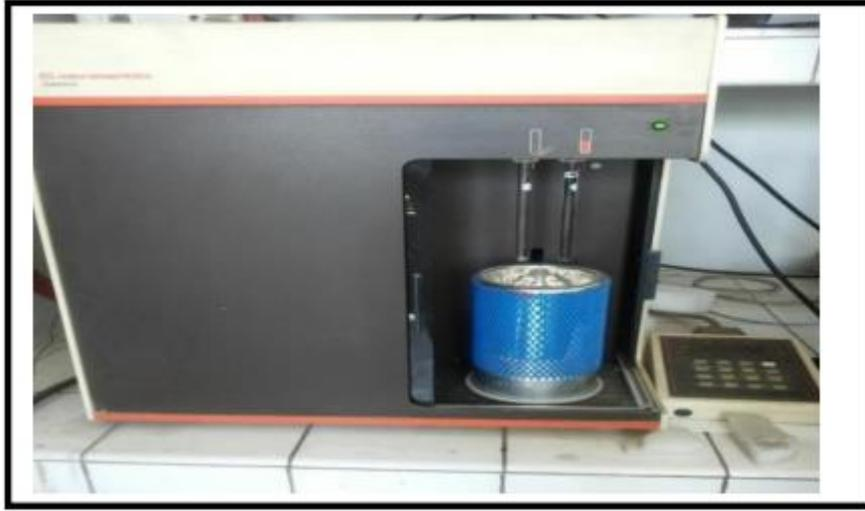
II-5 شكل :جهاز قياس السطح النوعي
