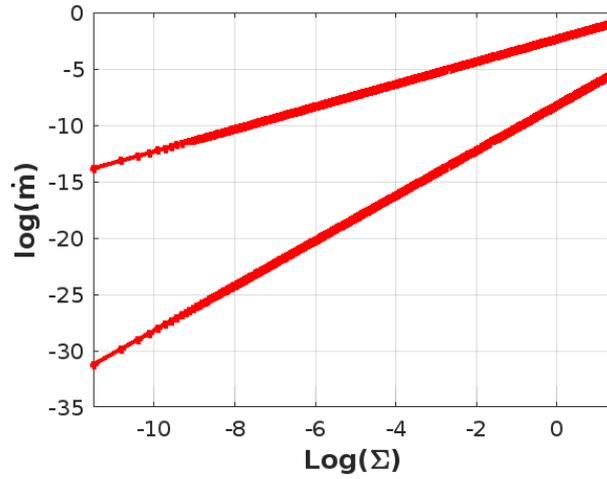
الشكل (III. 6ب): منحنى بياني يوضح التوازن الحراري لأقراص التراكم عند  $r = 30; \alpha = 1$
