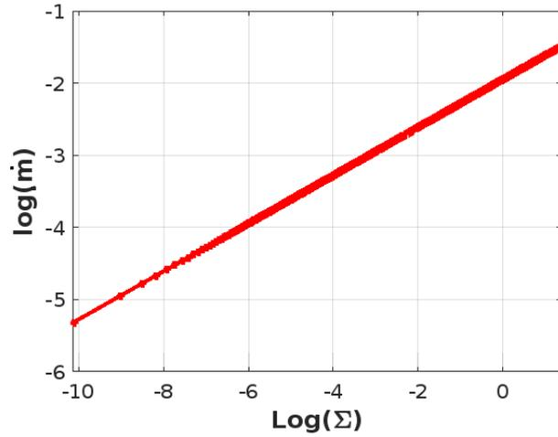
الشكل (III. 16): منحنى بياني يوضح التوازن الحراري لأقراص التراكم عند  $r = 30; \alpha = 0.5$
