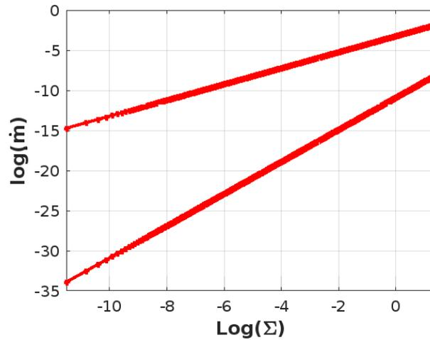
الشكل (III. 5 ب): منحنى بياني يوضح التوازن الحراري لأقراص التراكم عند  $r = 5; \alpha = 1$
