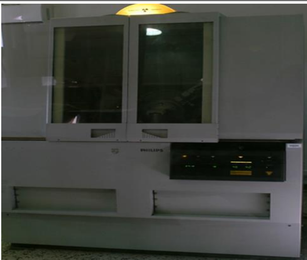
الشكل II-5: صورة فوتوغرافية لجهاز انعراج الأشعة السينية Philips X' Pert SW.
