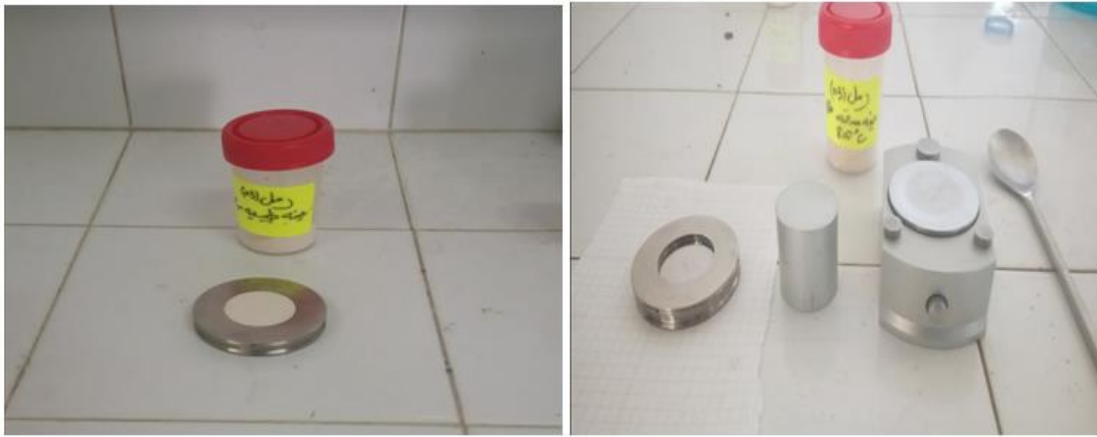
الشكل II-4: الأدوات المستعملة في تحضير العينة لإجراء انعراج للأشعة السينية عليها.
