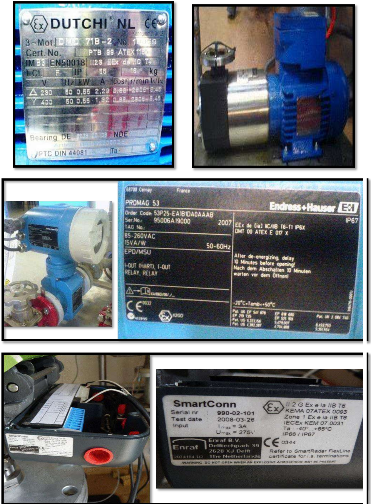
Figure III05: Marquage ATEX des équipements.
