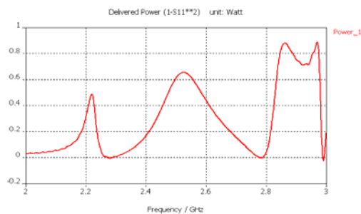
Figure 6 : Coefficient de couplage en puissance C [%] sur une gamme de fréquence [2-3 GHz]
