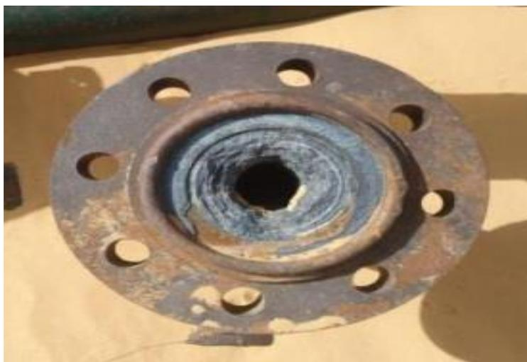
Figure I.7 : Dépôt de sulfate de baryum [1]
