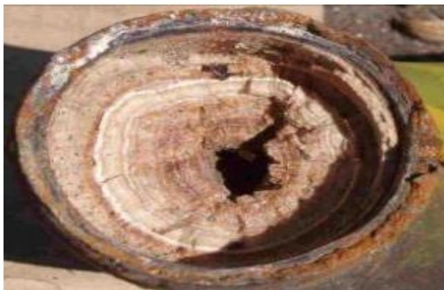
Figure I.4 : Carbonate de calcium (CaCO<sub>3</sub>) [7]
