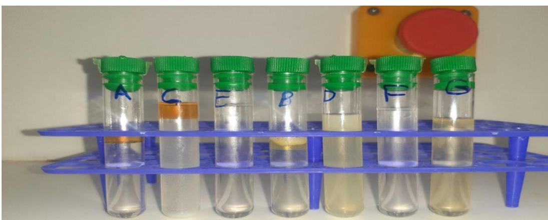
Figure III. 16 : compatibilité des mélanges: A, B, C, D, E, F, G à température ambiante après 48 heures de contact
