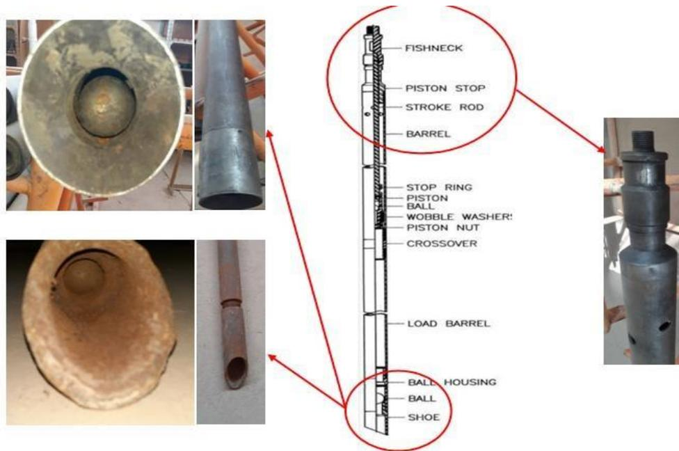
Figure II.7 : Schéma et image réel de Sand Bailer
