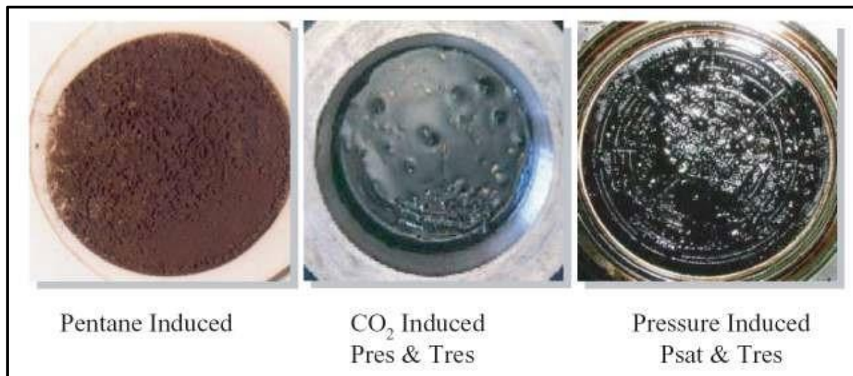
Figure I.9 : Floculation des Asphaltènes suivant différentes conditions.
