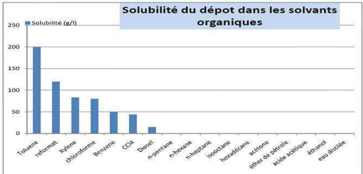
Figure I.19 : Solubilité des asphaltènes dans les différents solvants.
