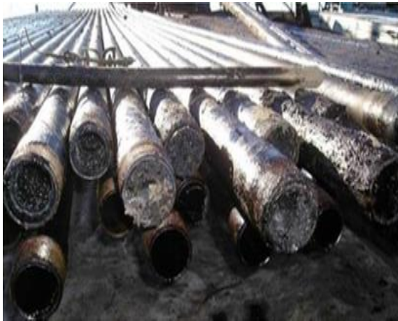
Figure II- 4 : Dépôt d'asphaltène dans les tubings de production
