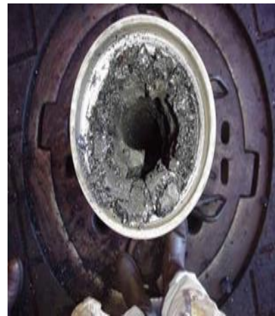
Figure II- 4 : Dépôt d'asphaltène dans les tubings de production
