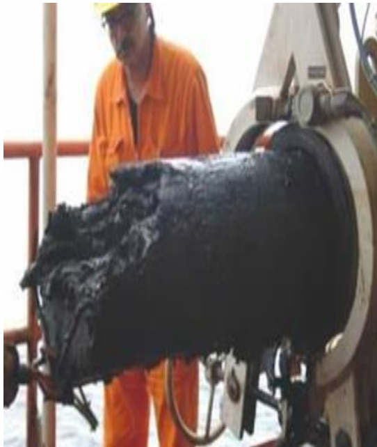
Figure II- 5 : Dépôt asphaltène après une opération de raclage.
