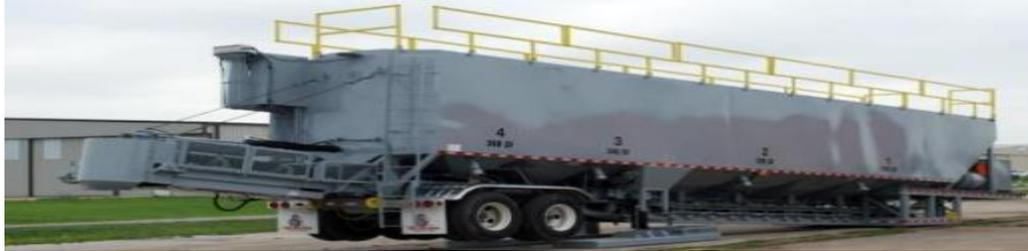
**Fig II-24 :** Réservoir de stockage d'agent de soutènement [7].
