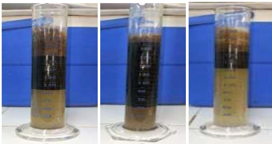
**Fig III-12 :** test d'émulsion entre EZC et pétrole brut.
