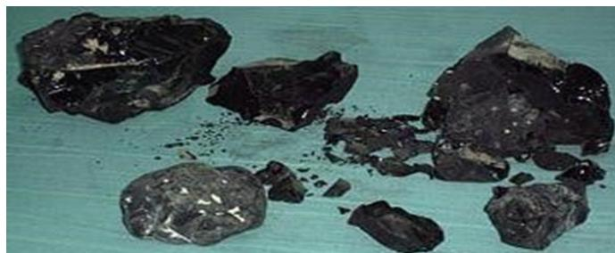
**Fig I-6** : dépôts d'asphaltènes.
