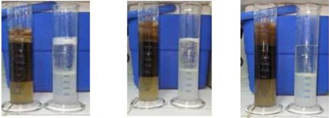
**Fig III-14:** Test refait pour (50/50) échantillon d'huile/Reformat et EZ Clean après 2min, 5min et 10min.
