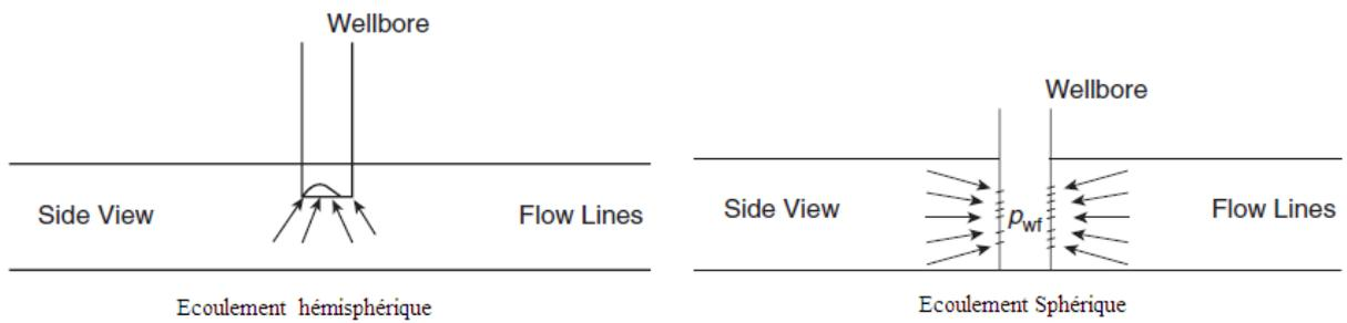
Figure I.8: Écoulement sphérique et hémisphérique [1].
