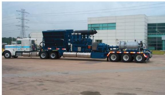
*Figure II.1. Une unité de pompage d'une puissance de 2700HHP. [08]*
