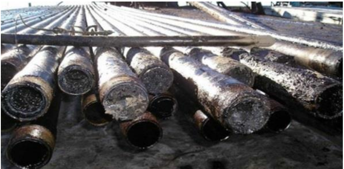
Figure (II.2): Dépôt d'asphaltènes dans les tubings de production.
