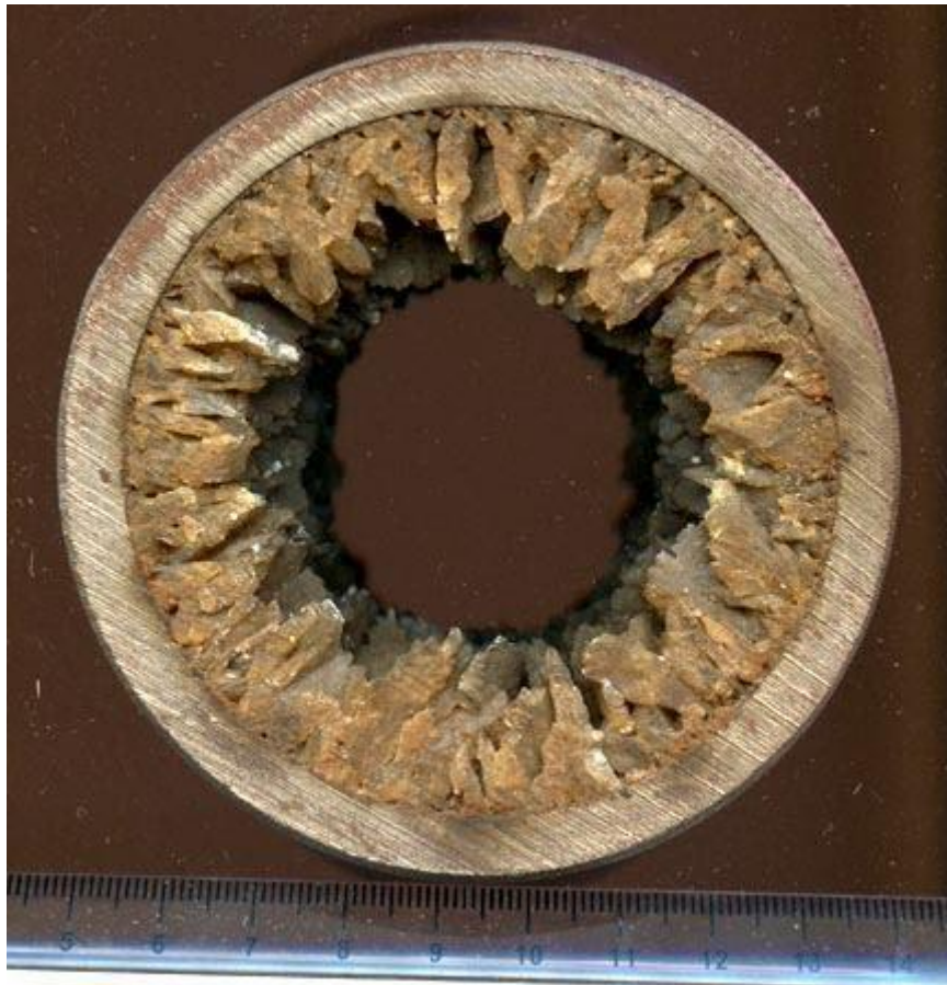
Figure(B.2): Dépôts de CASO4 dans une pipe de pétrole [7].
