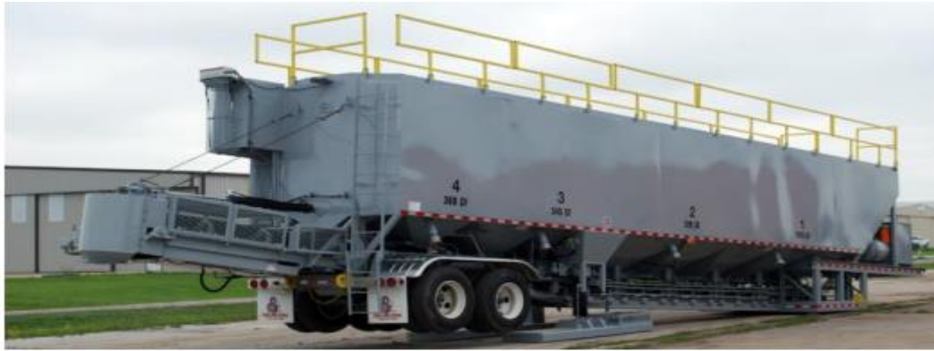
Fig. III.5. Réservoir de stockage d'agent de soutènement
