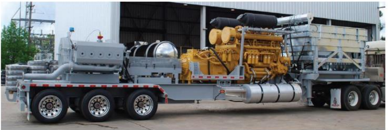
Fig.III.6. Pompe à haute pression
