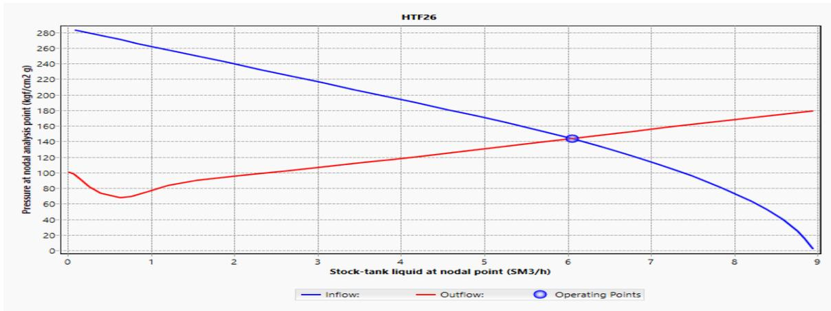
**Figure 9 : Point opérationnel du puits HTF26 après actualisation.**
