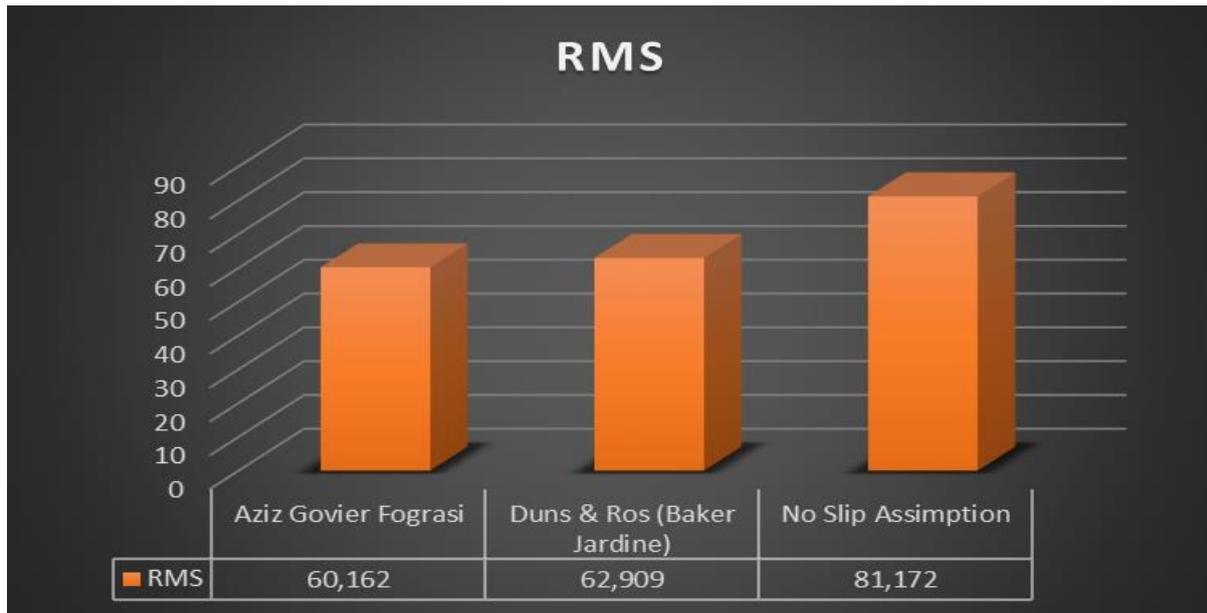
Figure IV.10 Calibration de RMS de chaque corrélation HTFN9.
