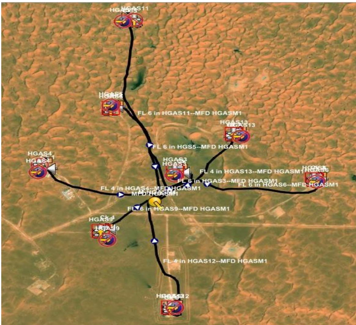
Figure IV. 2 : Structure du réseau HGASUD dans le PIPESIM (GIS MAP)
