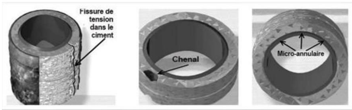
Figure I. 4 : Problème potentiel d'intégrité du puits lié au ciment.
