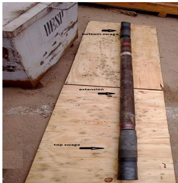
Figure III.13 :photo réelle des Composants du casing patch de HESP.
