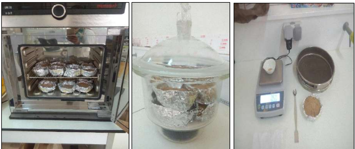
Figure n°15 : processus de mesure du calcaire
