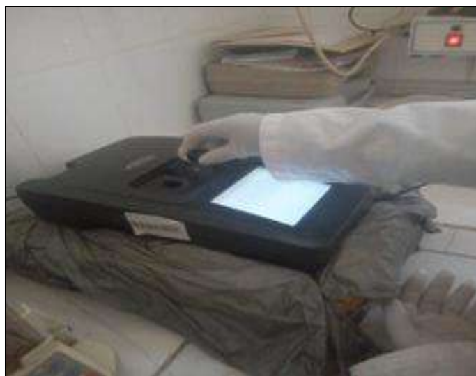
Figure n°16 : mesure de la teneur en chlorures par le spectrophotomètre DR 2800
