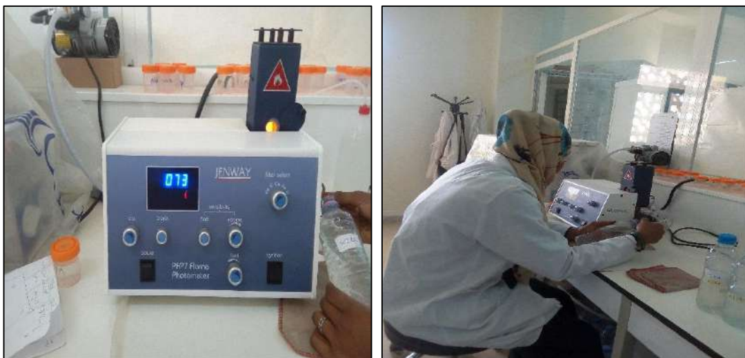
Figure n°18 : mesure de la teneur en Sodium et potassium par la photométrie à flamme Dr LANGE (JENWAY)
