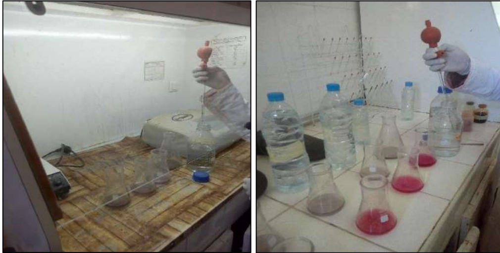
Figure n°19 : mesure de la teneur en calcium et en magnésium par la Méthode volumétrique
