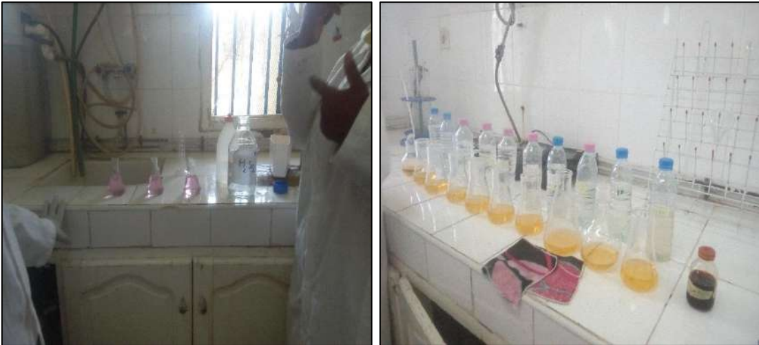
Figure n° 17 : mesure de la teneur en Carbonates et bicarbonates par la Méthode volumétrique de TAC et TA
