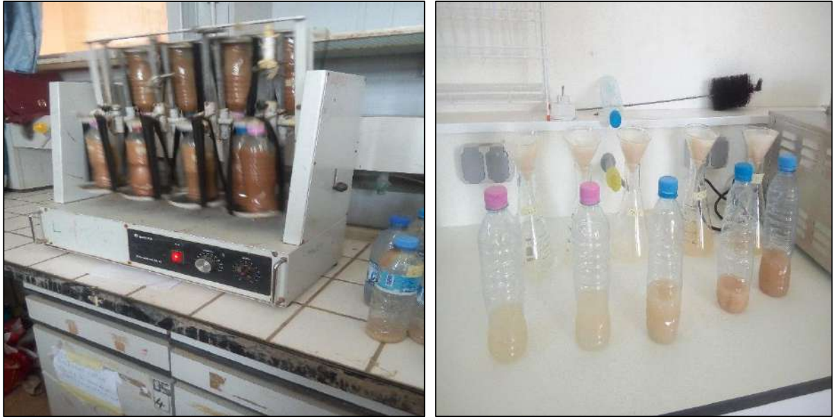
Figure n° 14 : Agitation et filtration de l'extrait dilué 1/5
