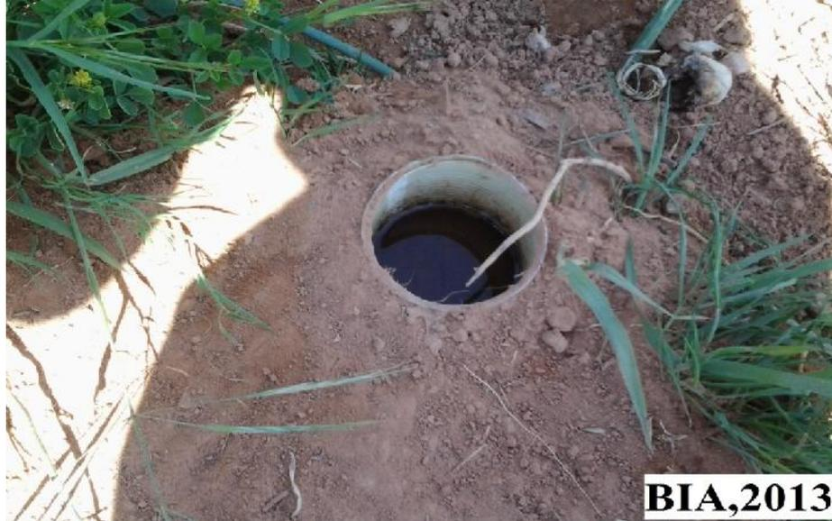
**Figure 15** - Mise en place d'un pot Barber (BIA, 2013).
