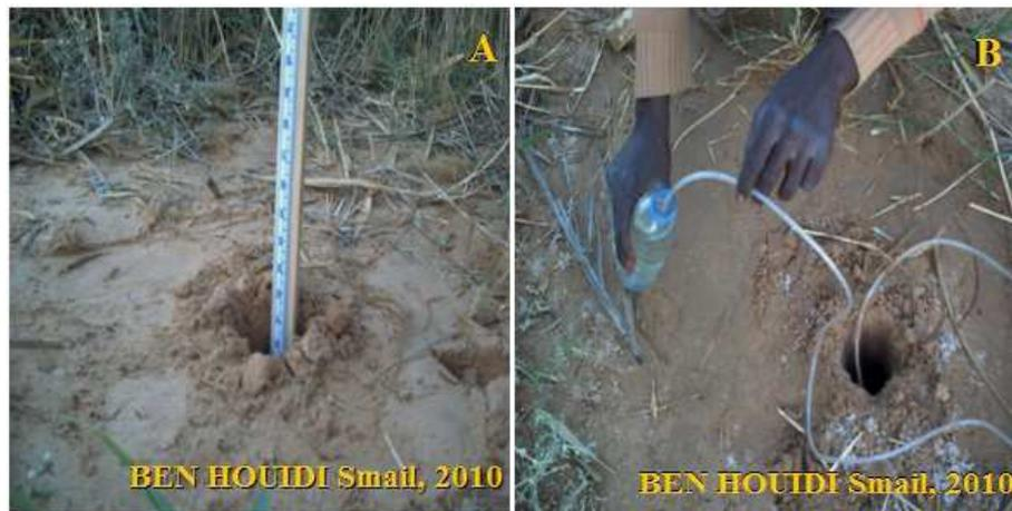
Photo 5. Mesures du niveau de la nappe (A) et prélèvements des eaux (B)
