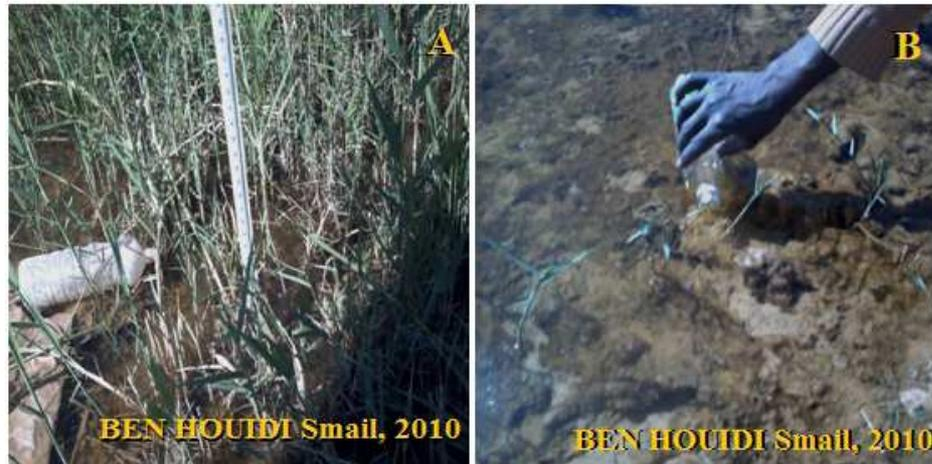
Photo 4. Mesures du niveau de la nappe (A) et prélèvements des eaux (B)
