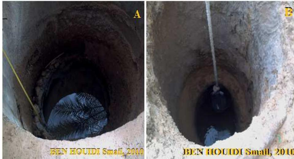
Photo 6. Mesures du niveau de la nappe (A) et prélèvements des eaux (B)
