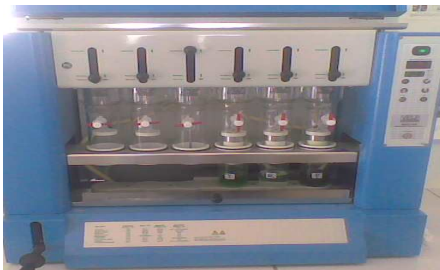
Figure 17. Extraction de l'extrait brut de S. persica par soxhlet
