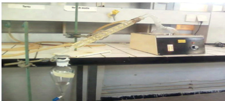
photo.2: Montage d'extraction par hydrodistillation.
