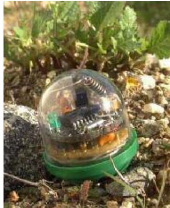
Figure 1-29 : Photo d'un nœud de capteur (environ trois centimètres de diamètre) sont maintenant utilisés pour la météo et surveillance des sols [17]
