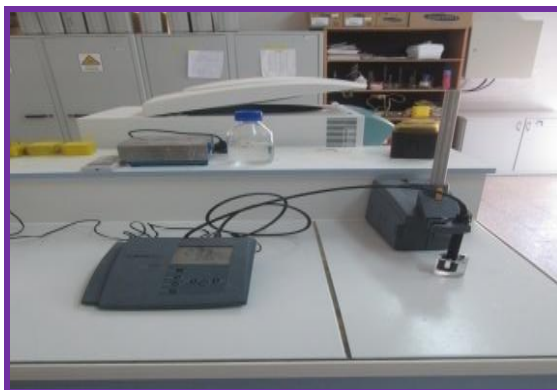
Figure n°09 : Le conductimètre électrique utilisé de type WTW series inolab cond720.
