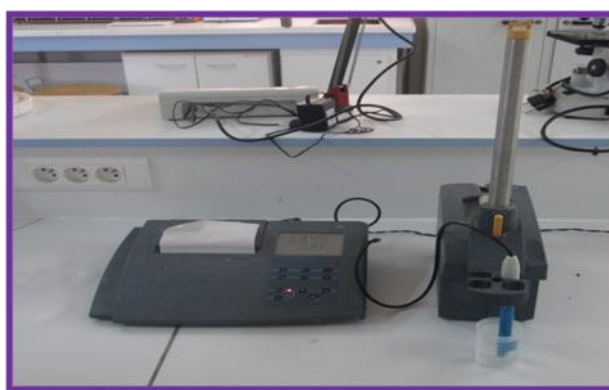
Figure n° 08 : Le pH-mètre utilisé de type WTW series inolab PH730.
