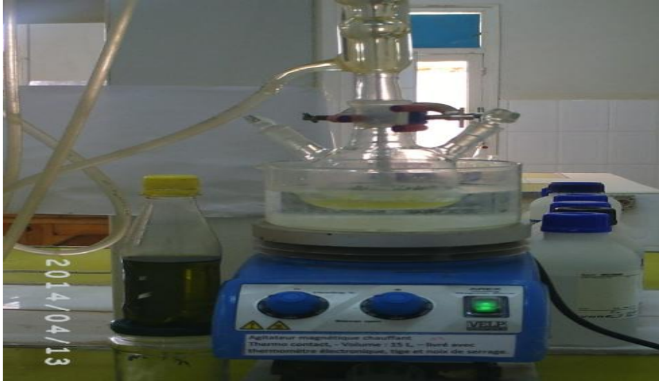
الصورة -3- : التركيب المخبري المستعمل في صناعة صابون زيت الزيتون.
