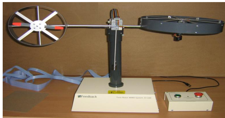
Figure : II.1 Simulateur TRMS
