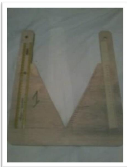
Photo- III.5– Déversoirs triangulaires En bois. ( \alpha=58,3^\circ ) (Déversoir 1(station entrée) , Déversoir 2(station sortie)).
