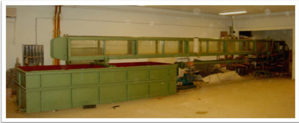
Photo - III.1- Dispositif expérimental d'un canal à surface libre.
