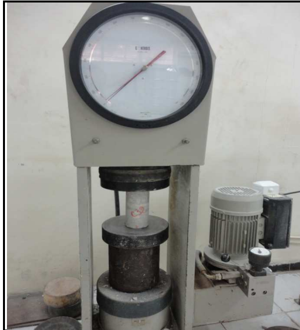
Photo (III, 14): Presse CONTROLS pour l'essai de compression.
