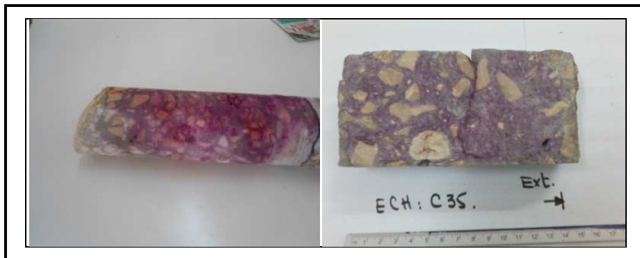
Photo (II, 1): Détermination de la profondeur de carbonatation.
