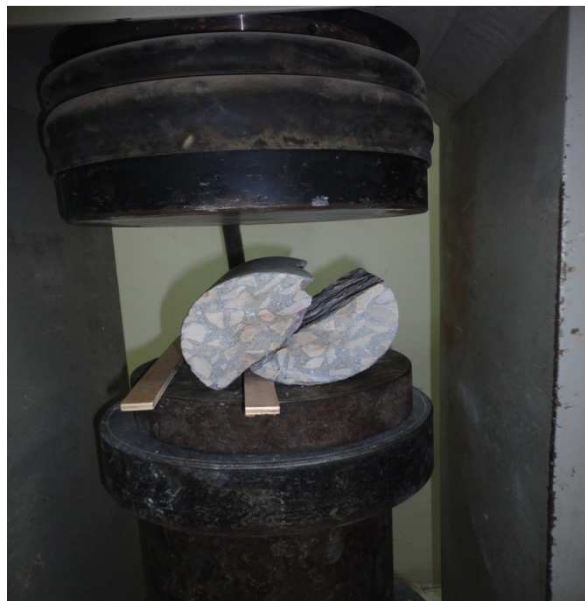
Photo (III, 15): Presse CONTROLS utilisé à l'essai de traction par fendage.
