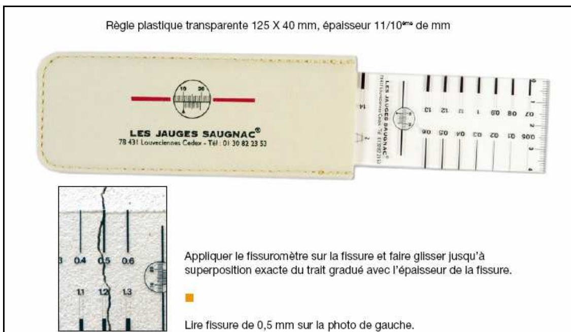
Photo (II, 4): Fissuromètre.
