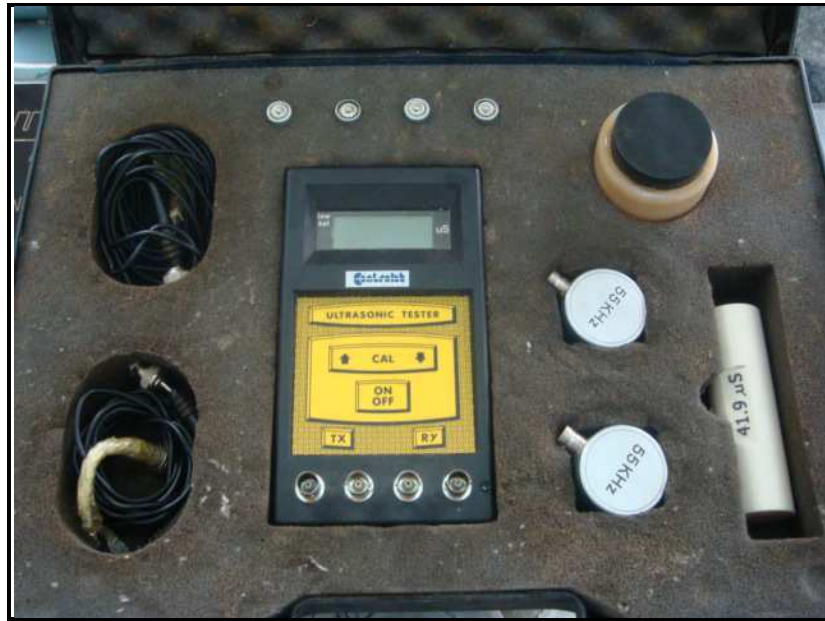
Photo (III, 16): Appareil de mesure d'auscultation sonore
