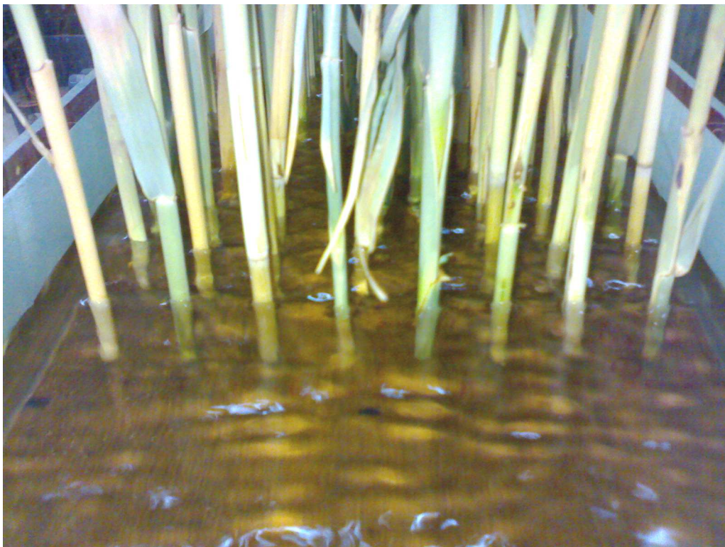
Figure 3.12 : Plaque d'essais avec une densité de 8U/dm^2 , ( \varnothing = 6 \text{ mm} ).
