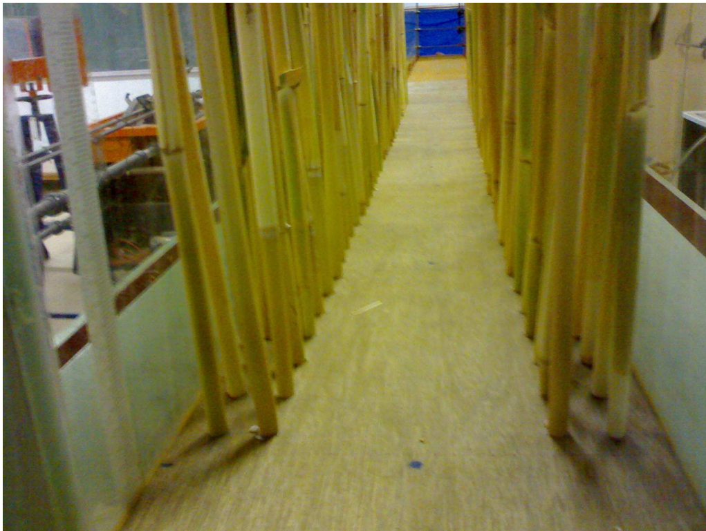
Figure 3.18 : Plaque d'essais avec une densité de 4U/dm^2 , ( \varnothing = 10 mm).
