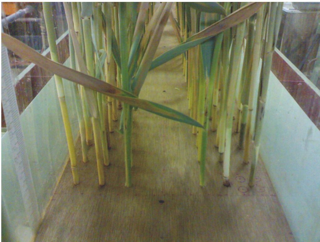
Figure 3.11 : Plaque d'essais avec une densité de 6U/dm^2 , ( \varnothing = 6 mm).
