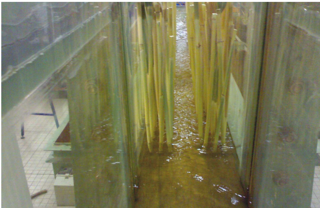
Figure 3.19 : Plaque d'essais avec une densité de 6U/dm^2 , ( \varnothing = 10 mm).
