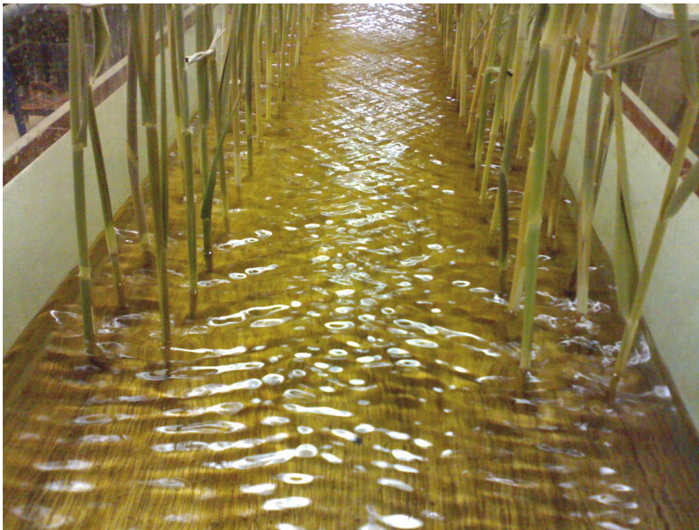
Figure 3.6 : Plaque d'essais avec une densité de 4U/dm^2 , ( \varnothing = 4 mm).
