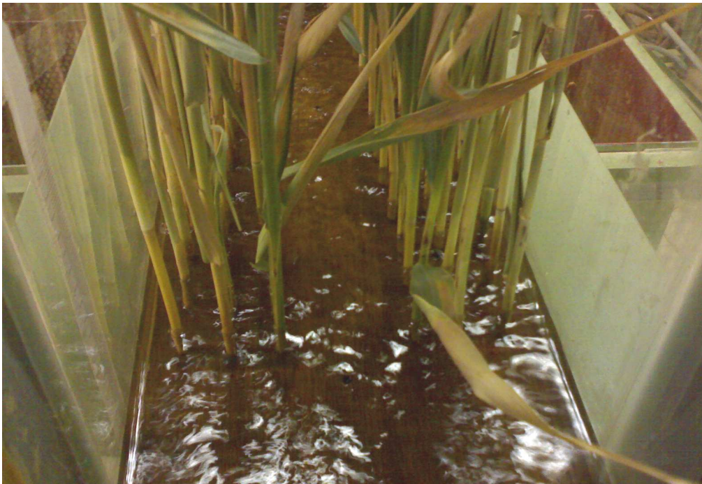
Figure 3.15 : Plaque d'essais avec une densité de 6U/dm^2 , ( \varnothing = 8 mm).
