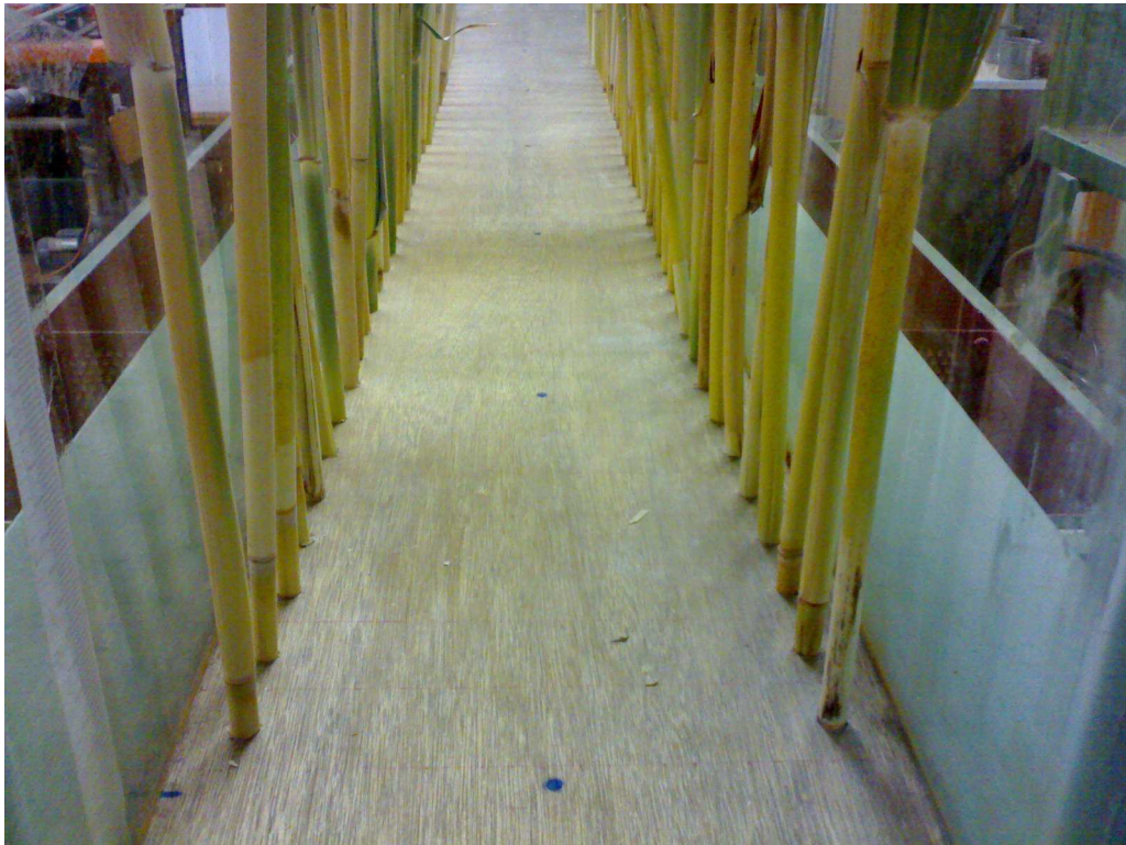
Figure 3.17 : Plaque d'essai avec une densité de 2U/dm^2 , ( \varnothing = 10 mm).
