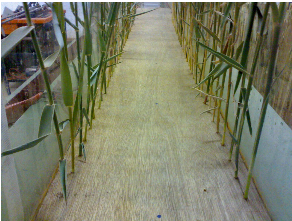
Figure 3.5 : Plaque d'essais avec une densité de 2U/dm^2 , ( \varnothing = 4 \text{ mm} ).
