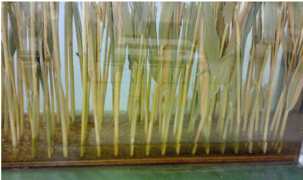
Figure 3.16 : Plaque d'essais avec une densité de 8U/dm^2 , ( \varnothing = 8 mm).
