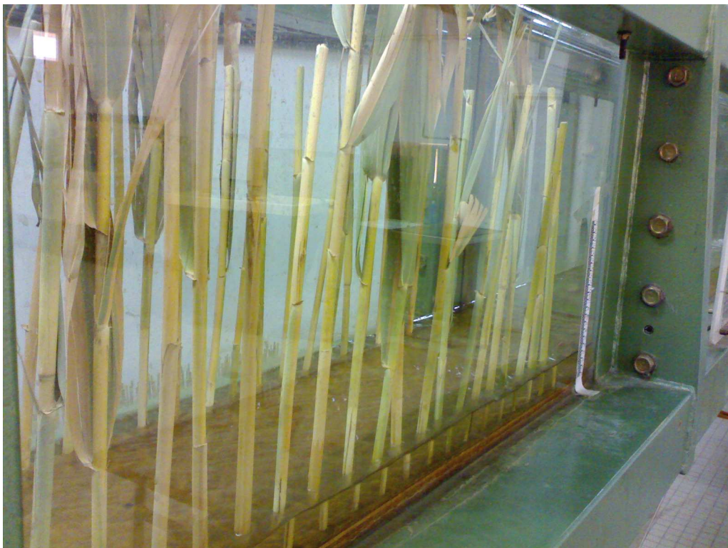
Figure 3.13 : Plaque d'essais avec une densité de 2U/dm^2 , ( \varnothing = 8 \text{ mm} ).
