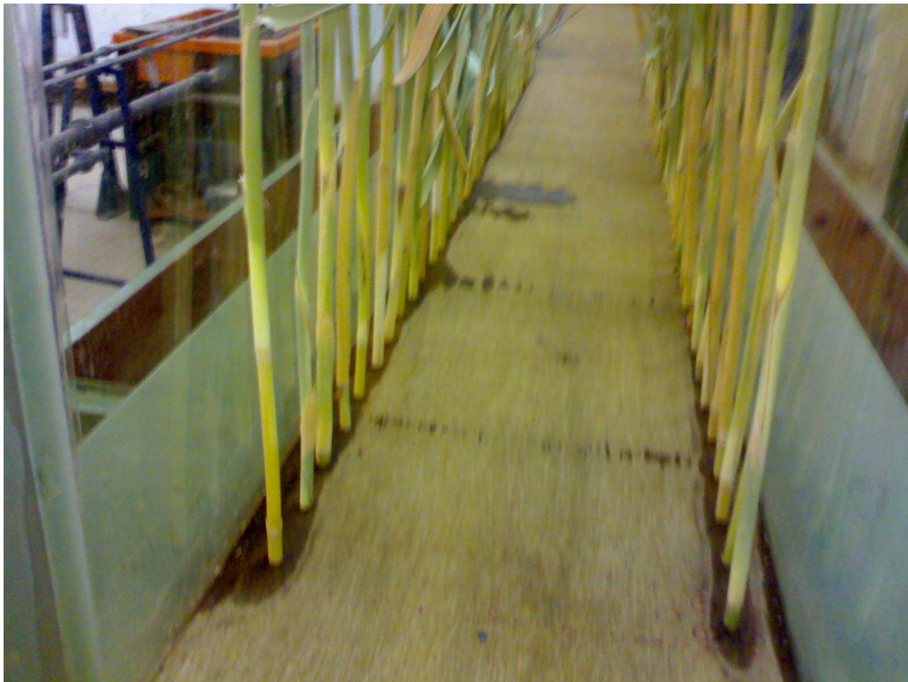
Figure 3.9 : Plaque d'essais avec une densité de 2U/dm^2 , ( \varnothing = 6 \text{ mm} ).
