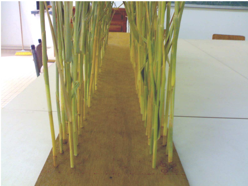
Figure 3.10 : Plaque d'essais avec une densité de 4U/dm^2 , ( \varnothing = 6 mm).
