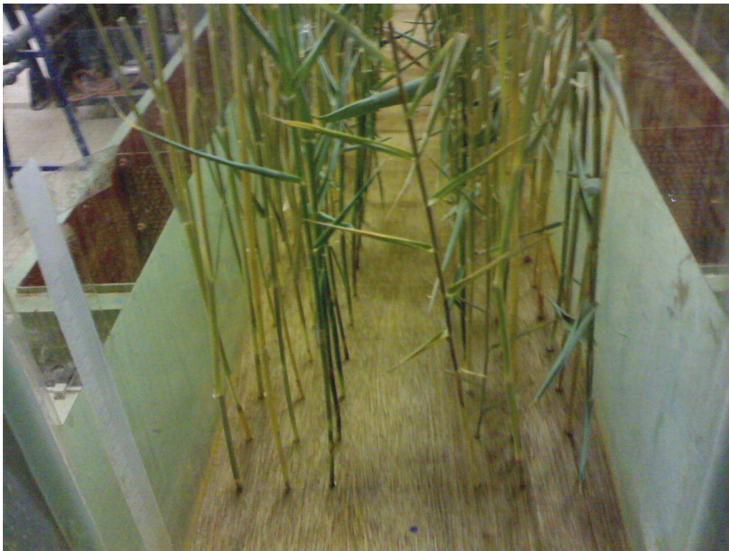
Figure 3.7 : Plaque d'essais avec une densité de 6U/dm^2 , ( \varnothing = 4 mm).
