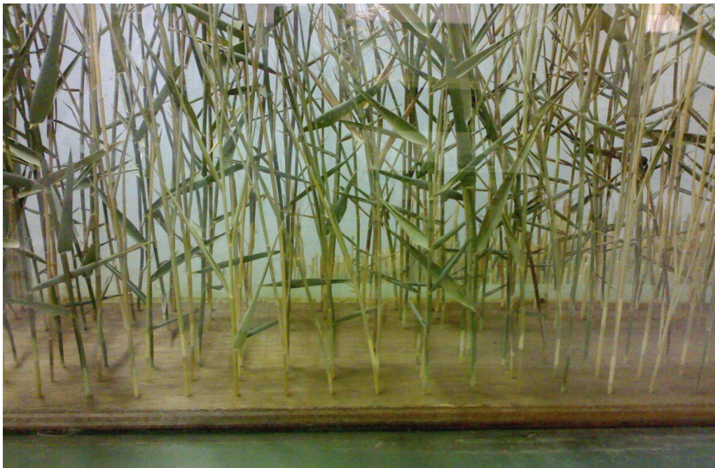
Figure 3.8 : Plaque d'essais avec une densité de 8U/dm^2 , ( \varnothing = 4 mm).
