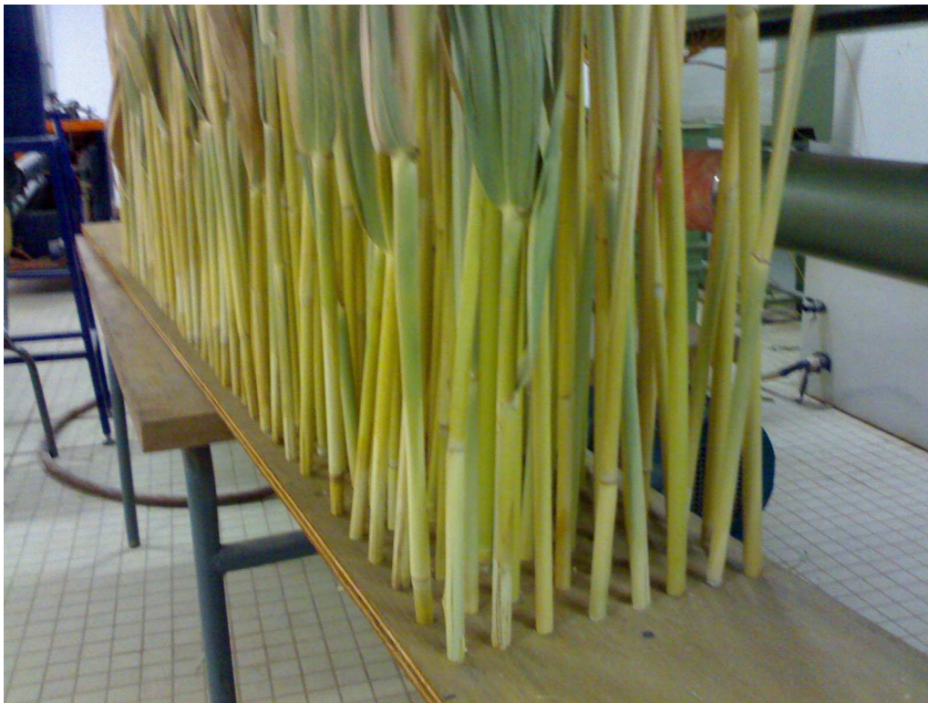
Figure 3.20 : Plaque d'essais avec une densité de 8U/dm^2 , ( \varnothing = 10 mm).
