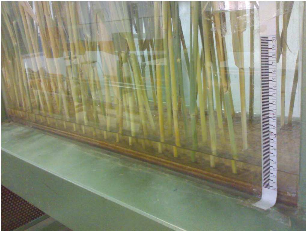
Figure 3.14 : Plaque d'essais avec une densité de 4U/dm^2 , ( \varnothing = 8 mm).
