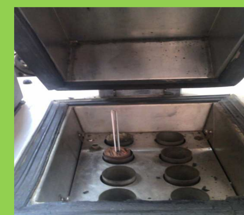
Figure (7) : Appareil pour mesurer le point d'écoulement
