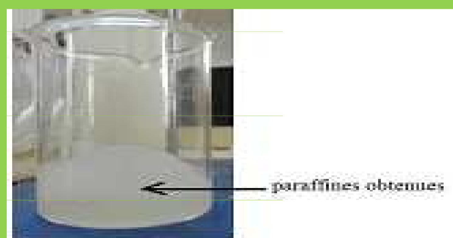
Figure (5): Paraffines obtenues après la décomposition du complexe.
