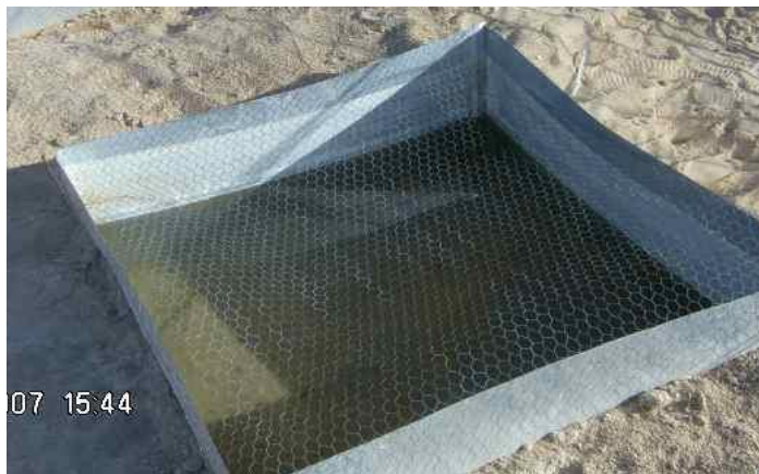
Figure 21. Bac enterré voisin type Colorado
