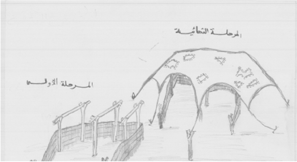
الشكل رقم 3: طريقة تثبيت الخيمة
