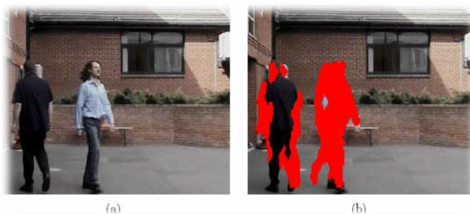
Figure 07 : Un exemple de la différence temporelle [6]. (a) une scène simple avec deux objets, (b) les régions rouges sont la différence entre deux images consécutives.
